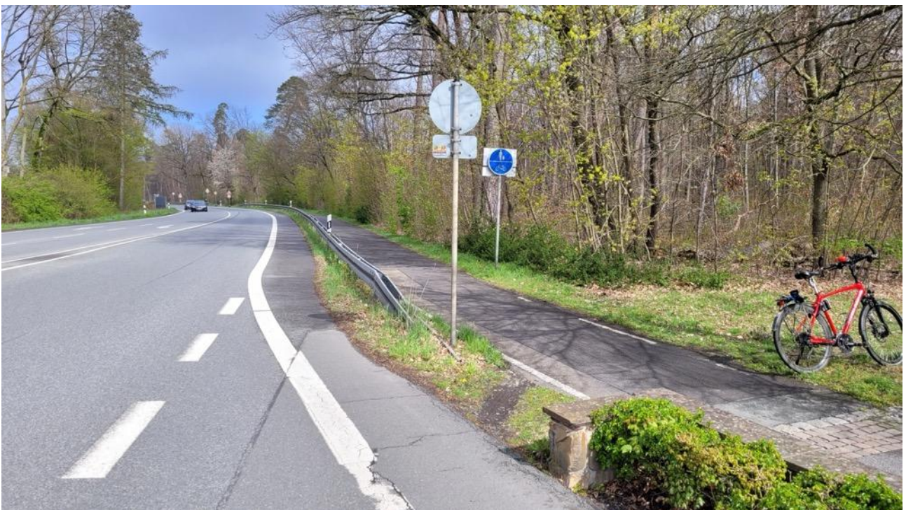
Zufahrt auf den Fuß-/Radweg? Reduktion der Leitplanke erforderlich, um gut in Richtung Offenbach radeln zu können. Achtung: Für aus Offenbach kommende Radfahrer bedarf es einer Querungshilfe!
