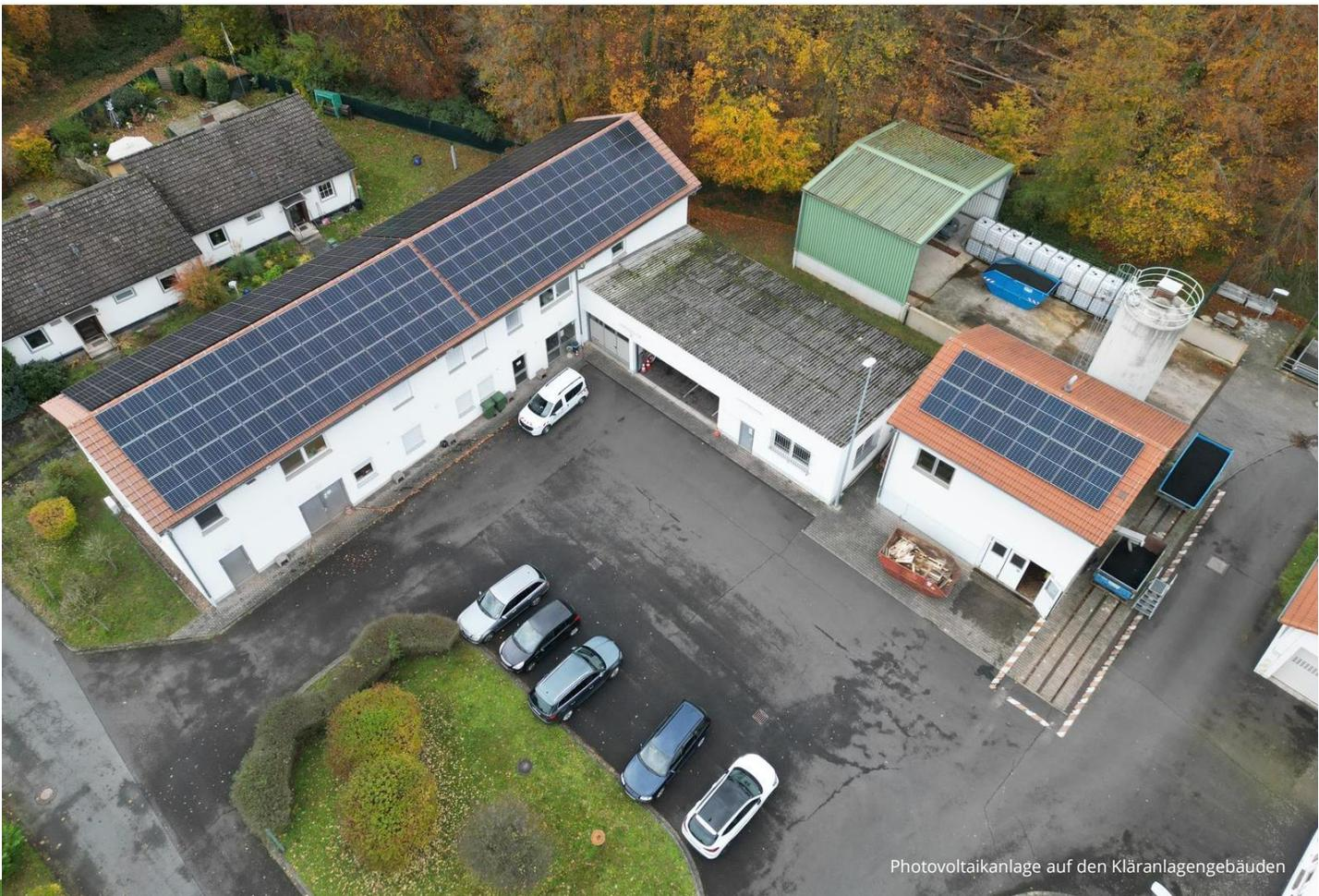
Photovoltaikanlage auf den Kläranlagegebäuden
